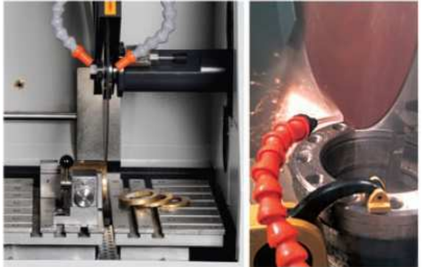
Automatische, serielle Trennungen planer Parallelschnitte
